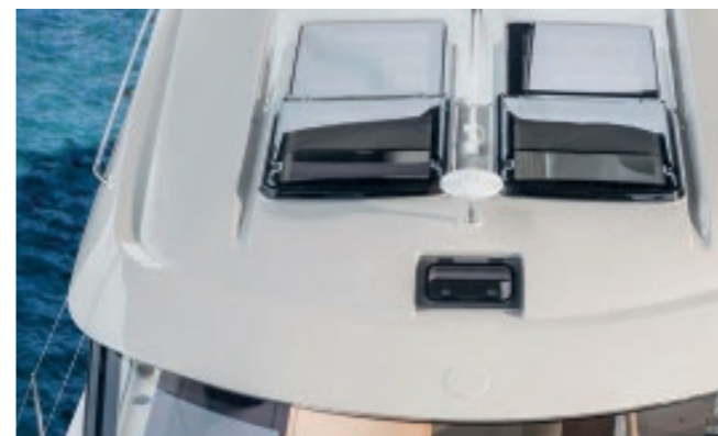
Innovatives elektrisches Schiebedach
