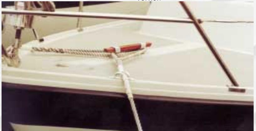
Bootsdeck nachher mit COELAN®-Bootsbeschichtung, weiss eingefärbt. Durch die Schichtstärke von 1 mm werden alle Haarrisse überdeckt.
